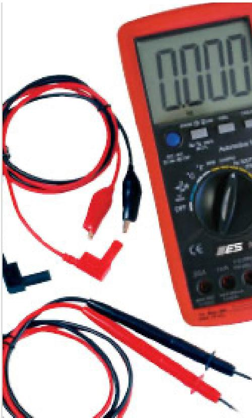
Completamente automático, lo que lo convierte en una herramienta fácil y eficiente de usar. Incluye dos juegos de cables de prueba, sensor de RPM, sonda de temperatura, batería de 9 voltios, manual de instrucciones y estuche de transporte. La captación inductiva de RPM cuenta con un interruptor de sensibilidad ajustable de cinco posiciones.
