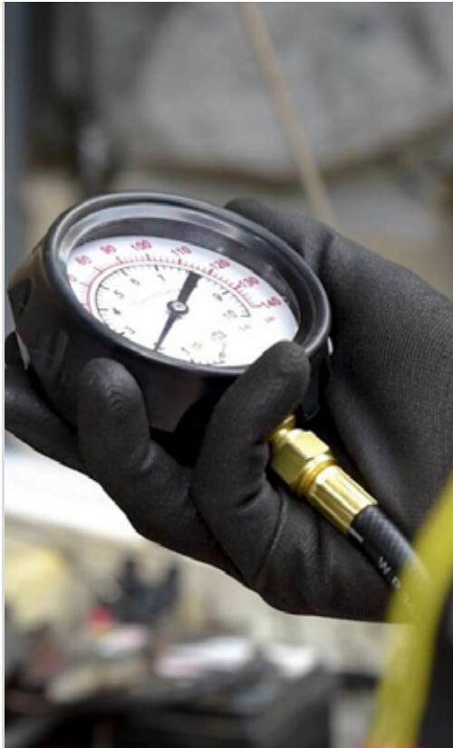
Este juego cuenta con tres cabezales de medición para verificar con precisión la presión de aceite de 0 a 800 PSI. Los medidores se leen tanto en el sistema métrico como en el estadounidense y vienen completos con protectores de caucho para los medidores. Quince adaptadores cubren prácticamente todas las aplicaciones.
