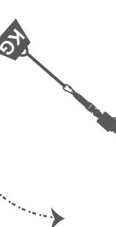
Se une el lanyard a un punto de anclaje y al otro extremo se le aplica la carga. Se eleva la carga por encima del punto de anclaje y se suelta, 5 veces.
